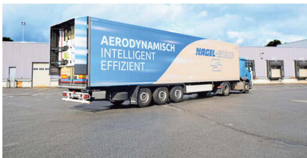
Im Rahmen eines Pilotprojekts zur Optimierung der Fahrzeugflotte hat die Nagel-Group zwei ihrer Sattelzüge mit innovativen aerodynamischen Elementen ausgestattet.
